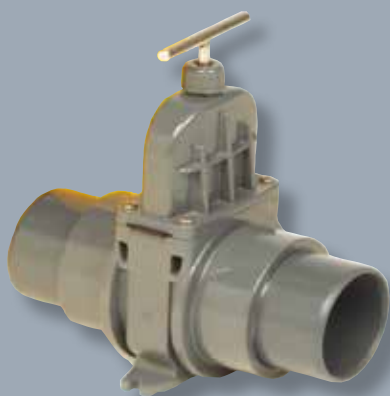
Vanne d'entrée PVC DN 100 ou DN 150 avec embouts de tube fixés pour un raccorde- ment direct à la bride de serrage de l'entrée, pour un gain de temps et d'espace.
